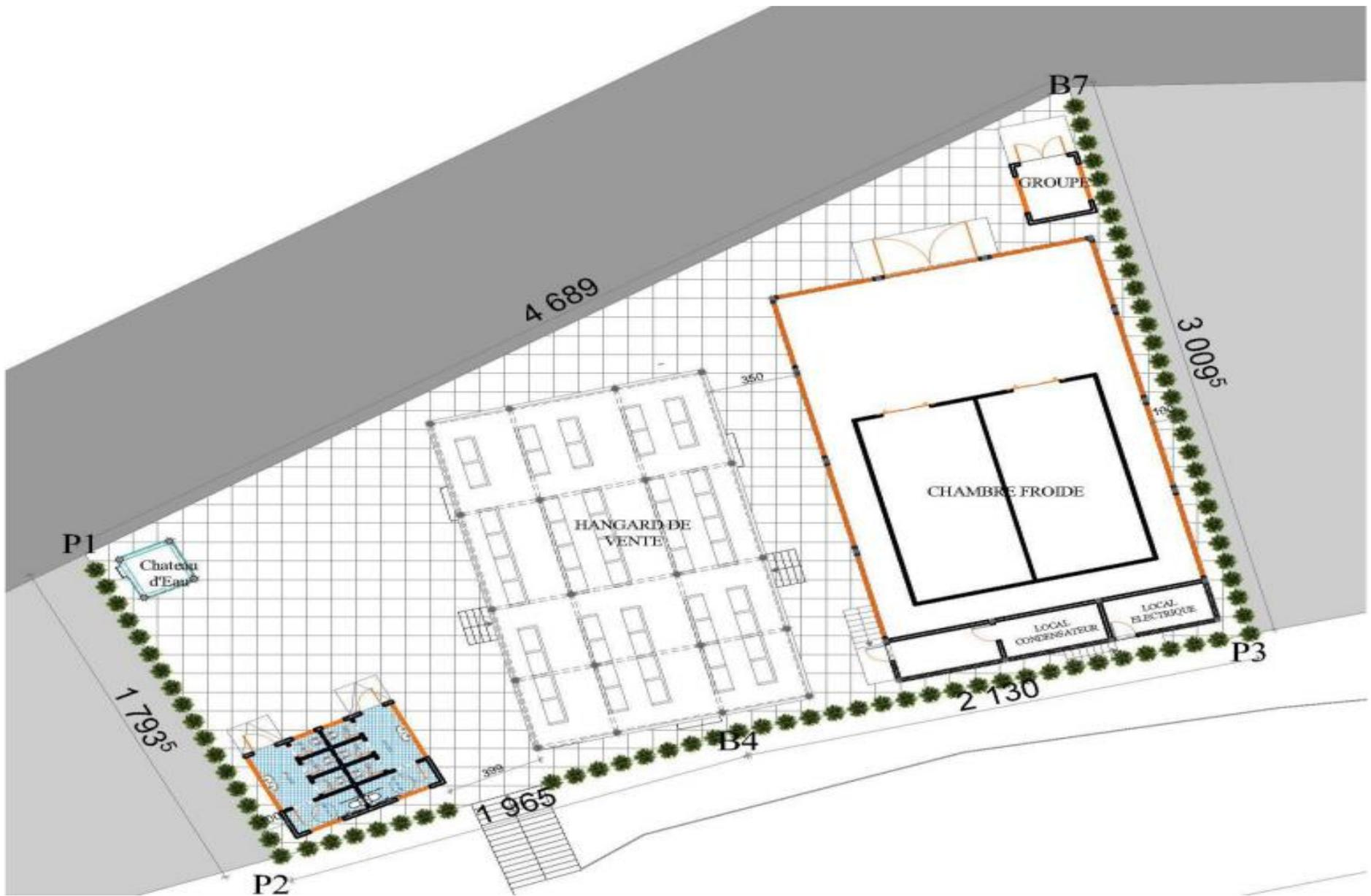
Figure 5 : plan d'implantation de la plateforme de vente y compris la chambre froide au km36 dans la commune rurale de Manéyah
