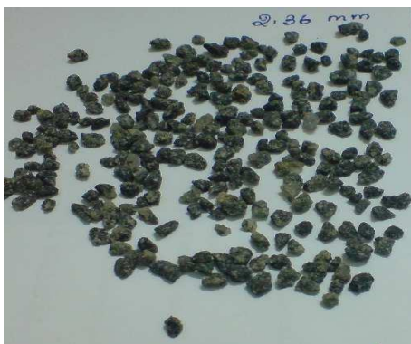
Good quality CS-Sand (2.36mm) - Cubical
