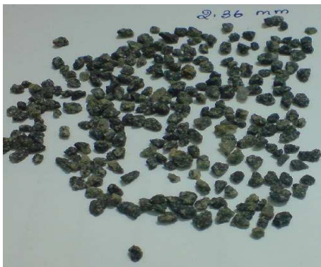
Good quality CS-Sand (2.36mm) - Cubical
