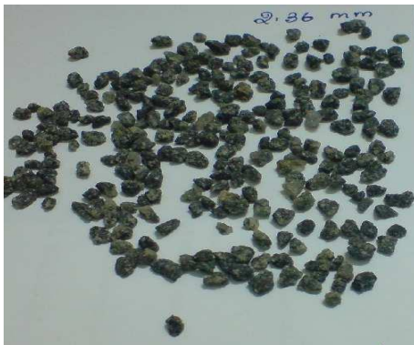
Good quality CS-Sand (2.36mm) - Cubical
