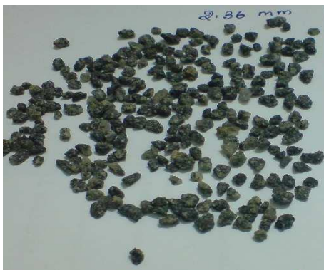
Good quality CS-Sand (2.36mm) - Cubical
