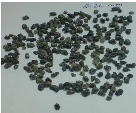
Good quality CS-Sand (2.36mm) - Cubical
