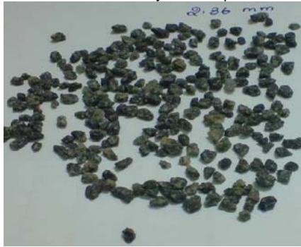
Good quality CS-Sand (2.36mm) - Cubical
