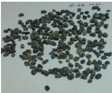
Good quality CS-Sand (2.36mm) - Cubical
