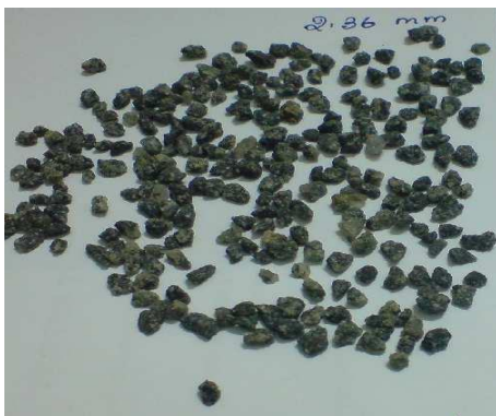
Good quality CS-Sand (2.36mm) - Cubical
